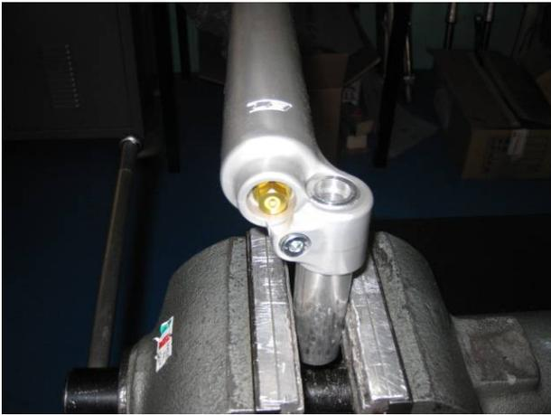
**!** ATTENZIONE! Utilizzando il perno ruota, stringendolo in morsa, infilare il gambale come da figura.
